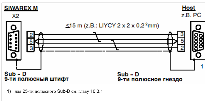
Рис. 2-10 Соединительный кабель для X2
